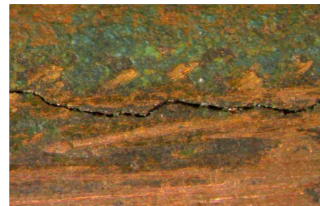
写真(4) 漏洩部に生じた粒界割れ
