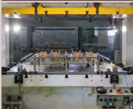
▲エコキュートの外装を作りあげる大型プレス機
