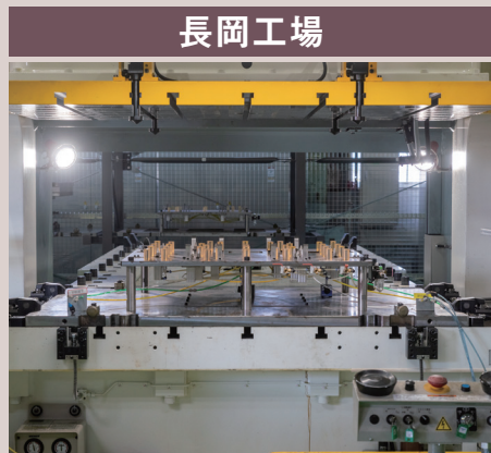
▲エコキュートの外装を作りあげる大型プレス機
