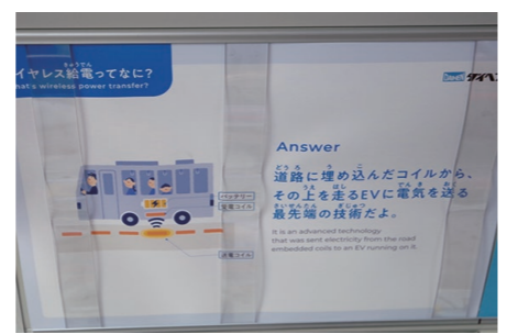
EVバスの内部には、ワイヤレス給電の仕組みなどを記載した説明書きが貼られている。
