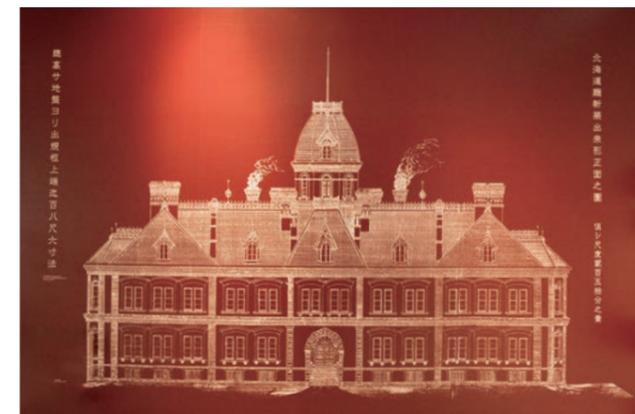
昭和43年の復元工事は図面が焼失して見つからず、古写真を目視しての工事となった。復元工事後に奇跡的に立面図が見つかったが、立面図とほぼ変わらない正確さであったという。これはその立面図。
