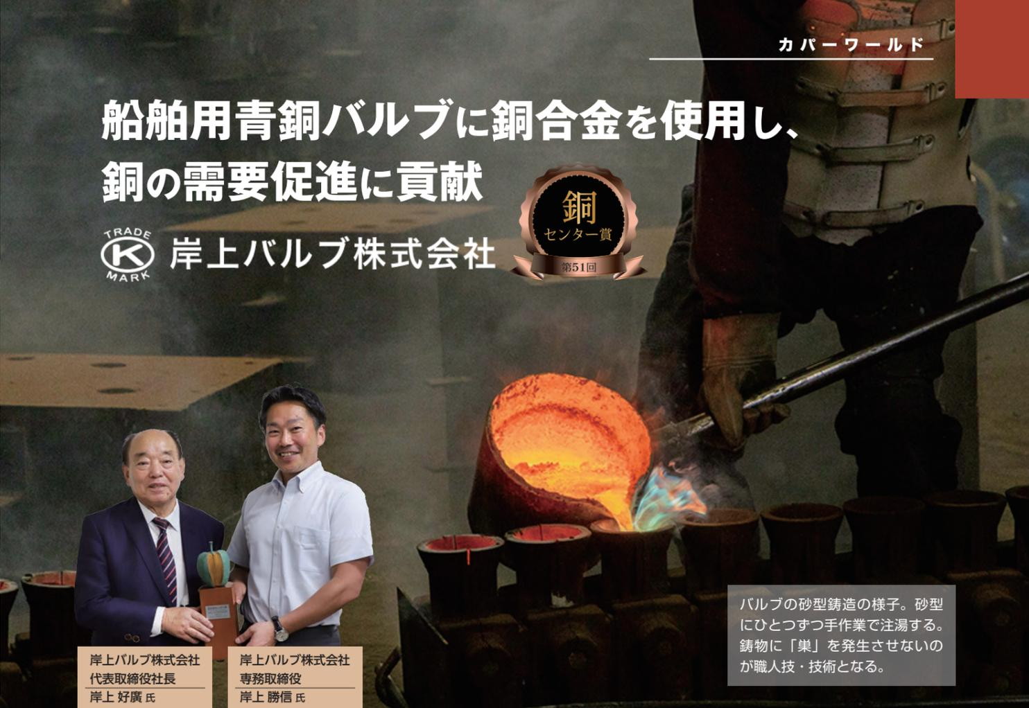
バルブの砂型鑄造の様子。砂型にひとつずつ手作業で注湯する。鑄物に「巣」を発生させないのが職人技・技術となる。
