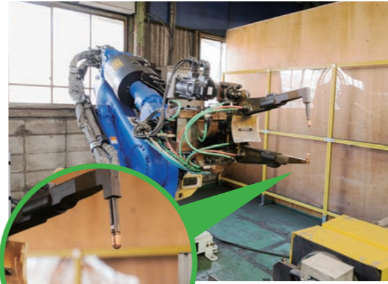
溶接ロボットの先端にキャップチップが装着されている。
