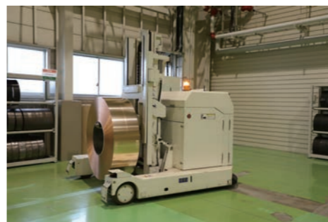
コイルは全自動半製品輸送機で運ばれていく
