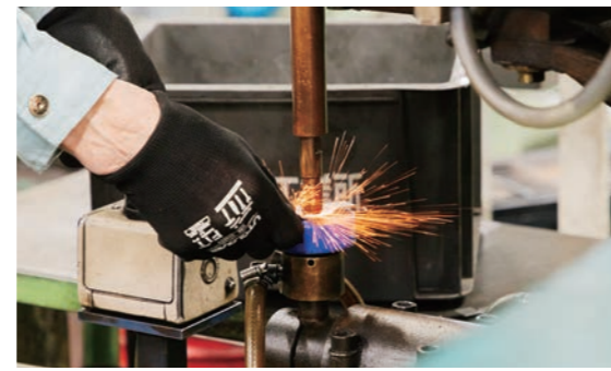
手作業でのスポット溶接の様子。
