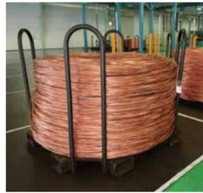
材料となる直径8mmの銅荒引線を製品に適した細さへと伸線機で加工。
