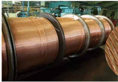
加工が完了した銅の撚線。各種新設備の導入で作業員1人あたりの生産量は約2倍、約40%の省エネも達成(600V-CVT、CETの場合)。
