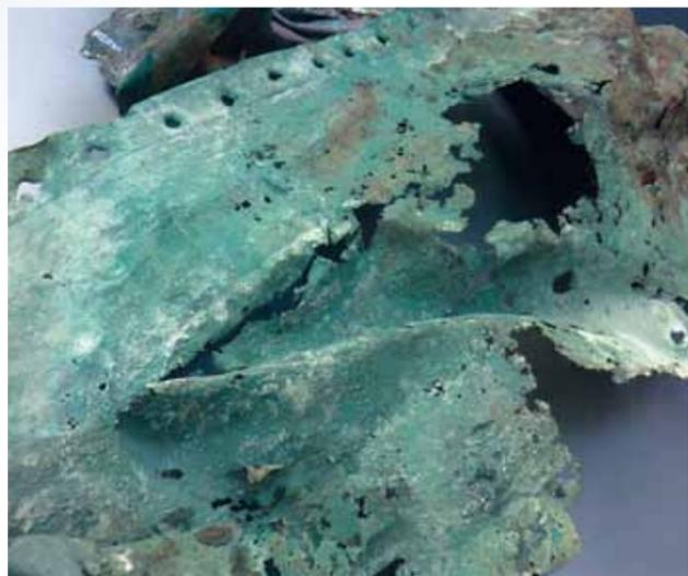
座礁で激しく破損した銅製の船体蓋
