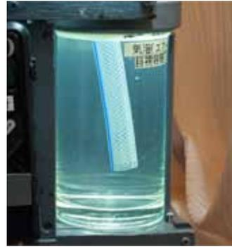
気泡で白濁した給湯水が透明に変化
