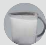
脱気前の白濁した給湯水
