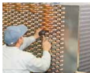
工程④ 差し込んだ銅管にU字の継手を ろう付けし、設計回路にする
