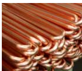
工程① 大量の銅管を U字に曲げ加工する
