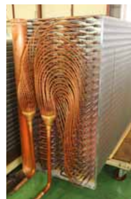
工程⑤ 均等に冷媒を送り込むための 分配器や複数の熱交換器を 繋ぐヘッダー管を装着する
