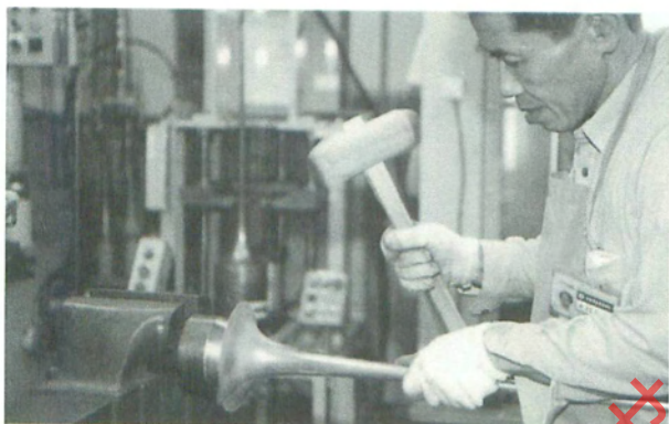
熟練技術者が木槌を使って、1枚の銅板からたたき出します
