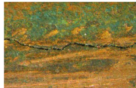
写真(4) 漏洩部に生じた粒界割れ
