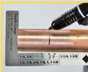
付属のデプスゲージを使用し、銅管の差し込み位置をチェックします。
