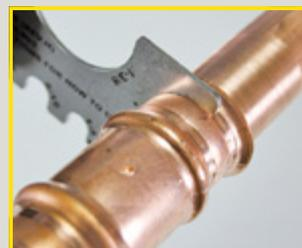
圧着完了後に付属のクランプゲージで外形を確認してください。
