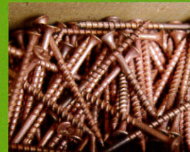
銅メッキしたビスを使い、ビスを 打った箇所から侵入する雨水に よる腐食も銅イオンで防止
