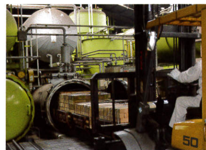
木材を加压注入タンクに入れ、約6時間かけて処理
