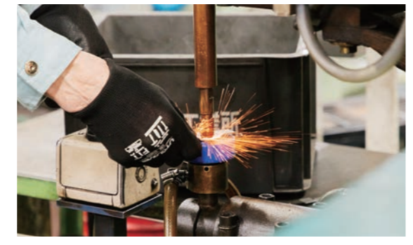
手作業でのスポット溶接の様子。
