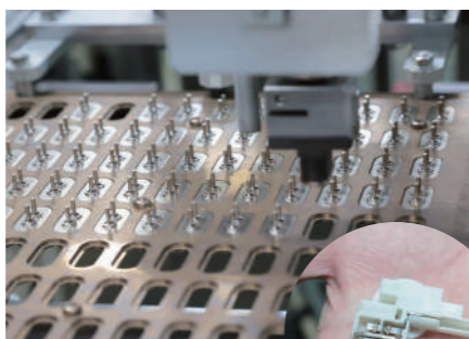
エアコンに、ワンタッチではめ込みできる銅芯材のリードピンを使った単相タイプ。
