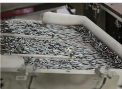
純銅の優れた伝導率を活かせるように、平らで滑らかに断面を加工した銅芯リードピンを使用。
