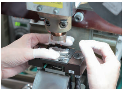
完成した製品には、(株)生方製作所の信頼を保証する、ブランド名がレーザー刻印されていく。
