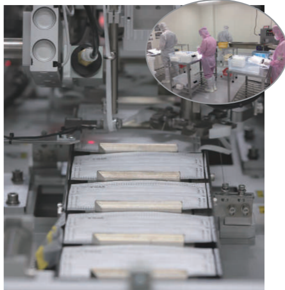
▲樹脂への金属蒸着シーン。特製の治具に部品をセットし、奥の蒸着釜へ。
