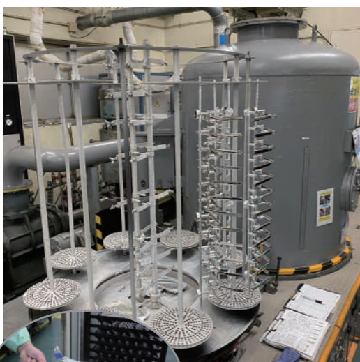
▲樹脂への金属蒸着シーン。特製の治具に部品をセットし、奥の蒸着釜へ。
