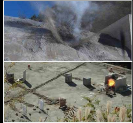
▲実験では、爆薬の量から銅板に付けるカーブの角度まで、成功率を高める様々なポイントを計算し、一つひとつ検証していった。 ©写真提供：JAXA
