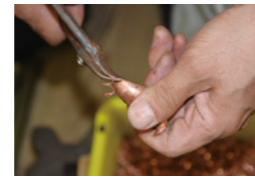
(右)注ぎ口を水切れのよい形に加工していく。当金などは初代の道具を使用している。(左)急須側の形状に合うように注ぎ口を切っていく
