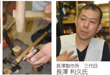
(右)注ぎ口を水切れのよい形に加工していく。当金などは初代の道具を使用している。(左)急須側の形状に合うように注ぎ口を切っていく
