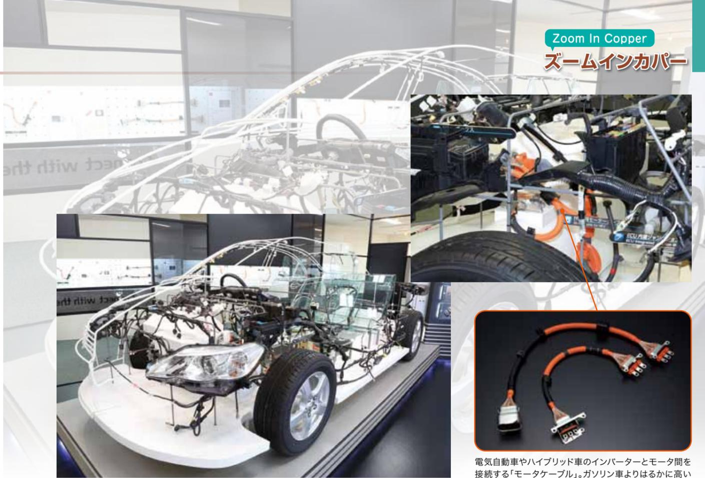
電気自動車やハイブリッド車のインバーターとモーター間を接続する「モーターケーブル」。ガソリン車よりはるかに高い200ボルトを超える高電圧と大電流に耐える仕様になっている
