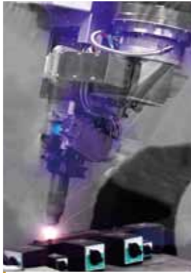
ファイバーレーザーによる溶接
