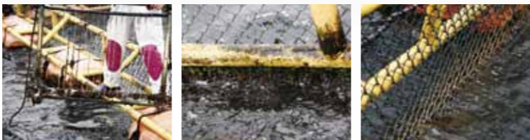
イケースの脇では他金属の実験も 鉄網には全面に藻が付着 銅網に藻は付いていない
