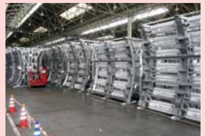
東京スカイツリーへ出荷前の送信アンテナ。角度や位置を固定したアンテナを6角形のゲイン塔にあわせて6分割にし、輸送した。
