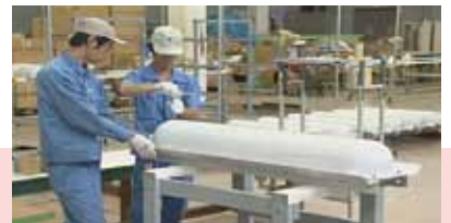
640個のアンテナを均一な品質にするため、ボルト1本の止め方から最適な方法が考えられた。
