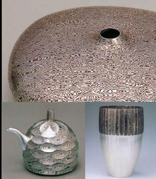
板の厚みは1.5mm程度で、仕上がりの模様を想像しながら、交互に金属板を数十枚重ね合わせていく。次に3~4cm程度の厚みとなった積層材料を金枠につめて固定し、フイゴ炉に入れ加熱し、目視によって融着が確認できたら取り出す。その後、たたいて薄く延ばし、その板の表面を削ると断層面が模様となって現れる。削り方によって模様は多様に変化し、ヤスリの角度を急にすると細かい模様に、ゆるやかな角度にすると大きな模様になる。さらに削った後でたたくと複雑な表情に変わる。
