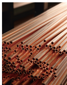
▲山積みされた細径銅管
