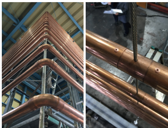
▲工場で仮組みされる銅管
