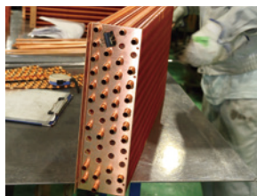
▲フィン部へ銅管の挿入
