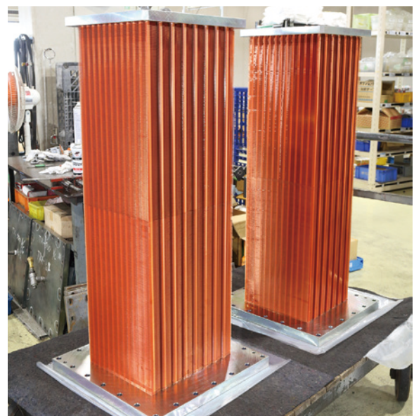
▲完成間近の熱交換器
