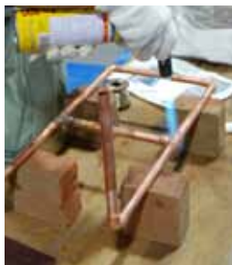
各接合部にフラックスを塗り、バーナーで接合部を加熱、ろう材を流し込んで接合していく
