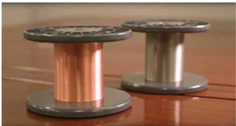
※1) 株式会社明清産業の独自技術が可能にした約100マイクロメートルの極細の銅箔糸は、可撓性、柔軟性、軽量性も備えている。
