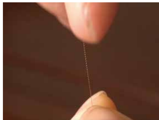
※2) ポリマー繊維に、極薄に伸ばした銅箔を巻き付ける、まさに専門メーカーの技ありの製造方法。
