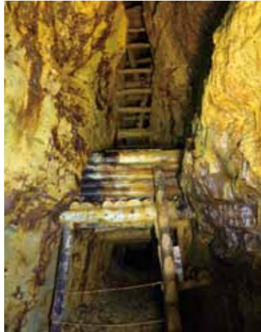
「グラウンドマイン」と呼ばれるシュリンケージ採掘法による採掘跡。鉱石を下から上へと採掘し続けることで巨大な谷ができ上がった
