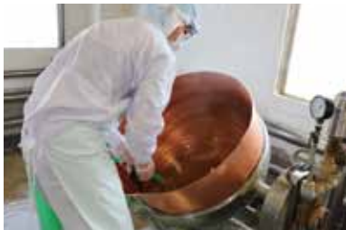
銅釜の効果を存分に発揮できるよう 使用後はつねにピカピカに磨き上げる
