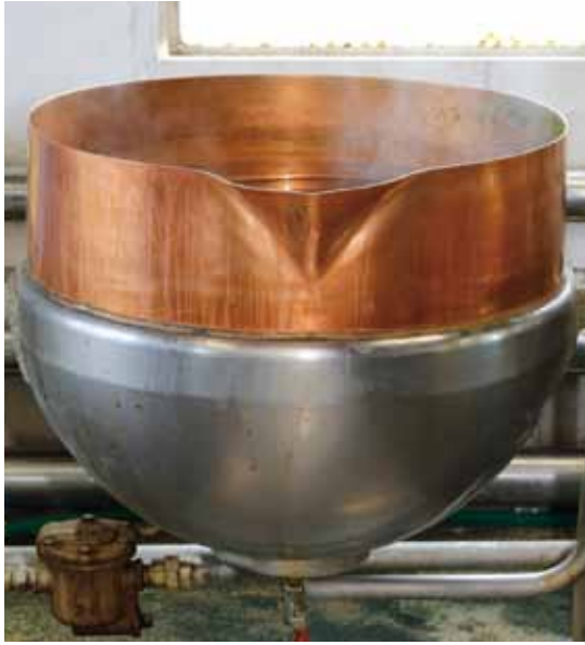
直径700mm、高さ380mm、厚さ約3mmの特注品の巨大な銅釜
