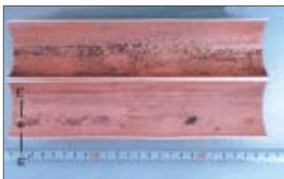
スケール除去、酸洗浄後
